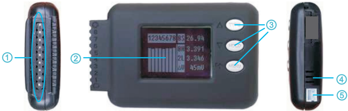
1 Akku Anschluss 2 LCD Display 3 Bedientasten 4. Beep 5. Alarm Anschluss
